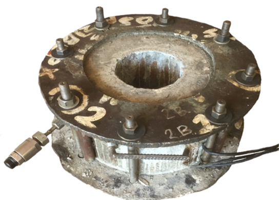
Рис. 2. Усовершенствованная конструкция железобетонной матрицы
